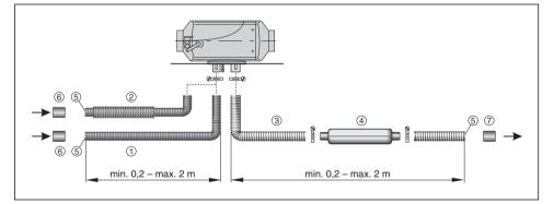
Combustion air hose, di = 25 mm
