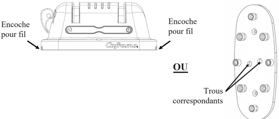
IV. Glisser la base du ventilateur sur la plaque de fixation fixée solidement. Fixer le ventilateur sur la plaque de fixation avec les deux vis comprises.
