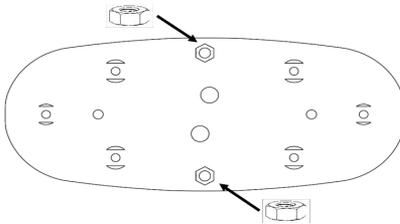
Placer les écrous dans les trous hexagonaux à l'arrière de la plaque de fixation avant le montage
